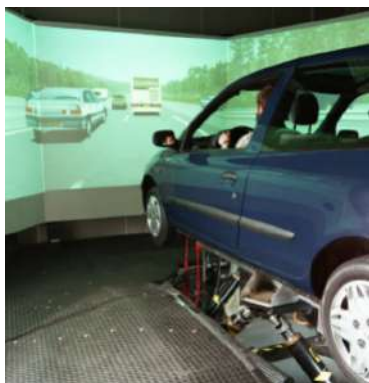
(a) Simulateur de conduite de Renault [Rey+00]
