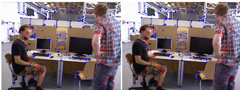
Figure 5.23 – Résultats de la détection des points d’intérêt dynamiques sans (gauche) et avec (droite) le DAM (points d’intérêt statiques et dynamiques, respectivement, en bleu et rouge)
