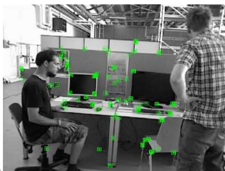
(a) Nombre moyen de points d'intérêt dynamiques rejetés par image via le DAM. (b) points d'intérêt statiques conservés avec le DAM.
