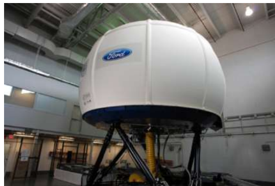
(b) Simulateur de conduite Virtex de Ford [Gra+01]
