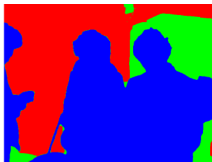
Figure 6.12 – Seuils liés à la profondeur (premier plan en bleu, plan intermédiaire en vert et arrière plan en rouge)
