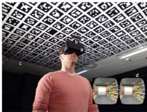
Figure 4.20 – Système CAVE pour la réhabilitation via un simulateur de marche.
