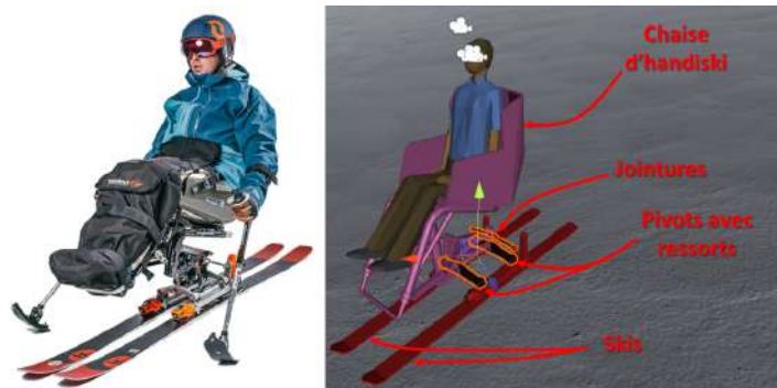
Figure 8.16 – Modélisation CAO d'un modèle double-ski d'handiski.
