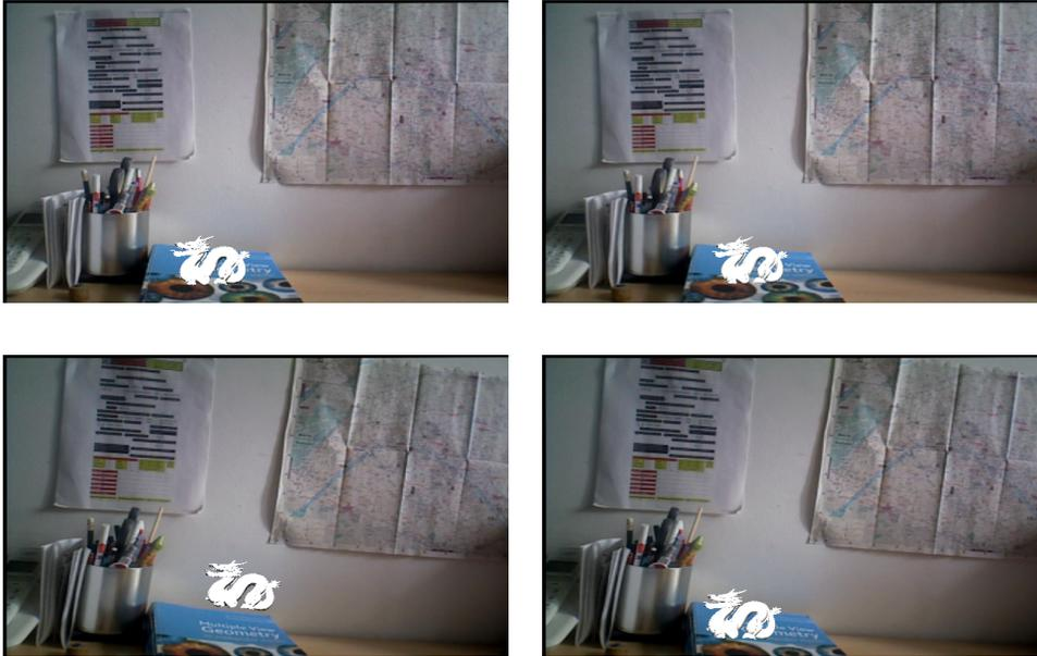
FIGURE 5.4 – Application de réalité augmentée, le dragon est virtuel. Les images de gauche correspondent aux captures du *SLAM* monoculaire, celles de droite aux captures du *SLAM* multi-capteurs. La première ligne correspond à des images en début de séquence, la seconde à des images de fin de séquence.
