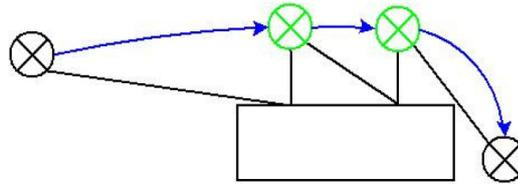
FIGURE 109: Principe de la création d'une trajectoire vers un objet
