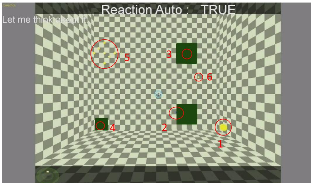
FIGURE 131: Environnement virtuel d'évaluation : six situations d'objets aux attributs différents, certains cachés, pour illustrer l'assistance. L'état de processus de décision (en attente, en réflexion ou déclenchant des assistance) et le mode automatique ou non sont affiché en haut de l'écran.
