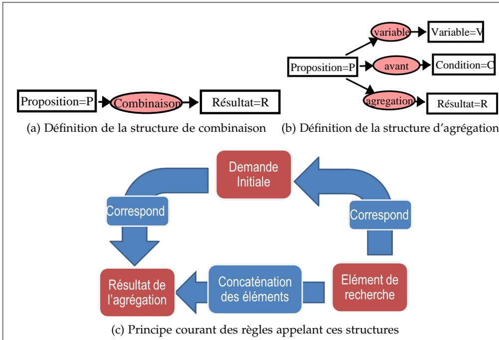
FIGURE 82: Illustration de la notion d'agrégation
