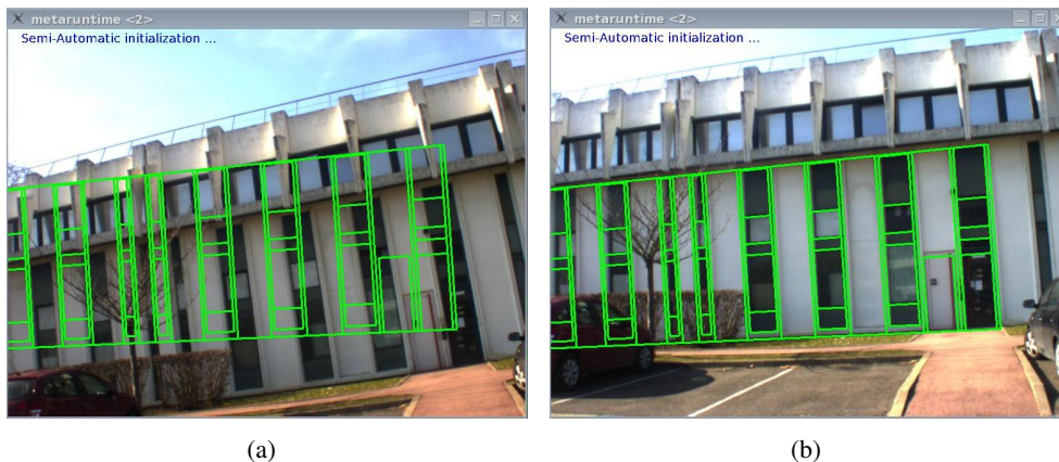
FIGURE 2.14: (a) Rendu du modèle filaire (b) Alignement manuel du rendu avec la vue courante
