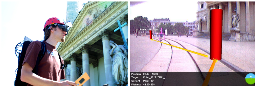
FIGURE 1.18: La plate forme Studierstube [Reitmayr et Schmalstieg, 2003] (a) La plate-forme matérielle (b) Exemple d'augmentation
