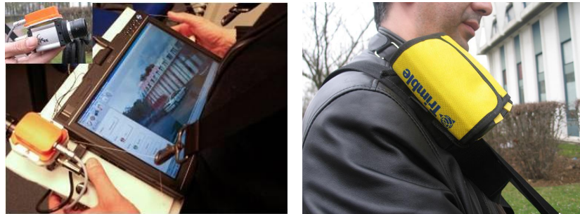
(a) Tablette-PC avec la caméra et la centrale inertielle
