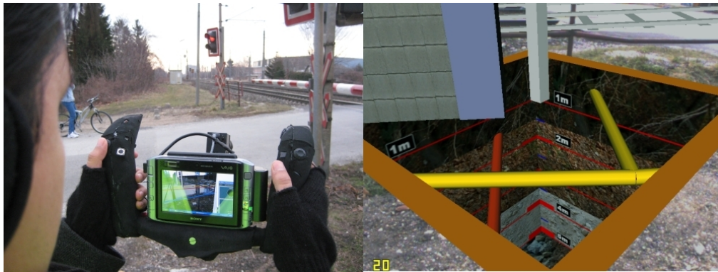
FIGURE 1.23: (a) Prototype de Vidente (b) Visualisation des tuyaux de canalisation [Schall et al., 2007]
