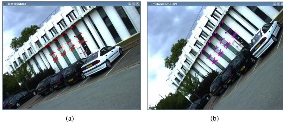
FIGURE 5.5: (a) Image de référence (b) Projection des points avec l'homographie calculée
