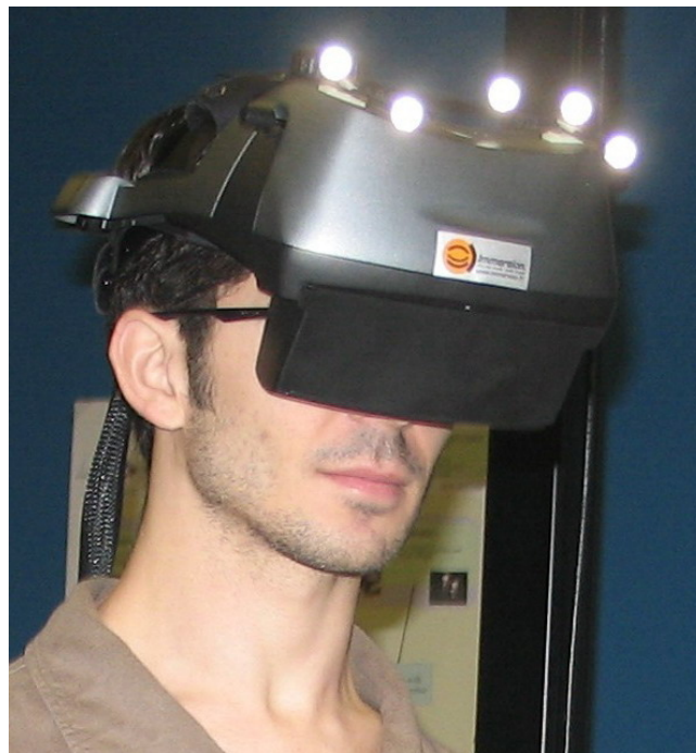
FIGURE 1.29 – Visio-casque avec accusation optique de la position de la tête.
