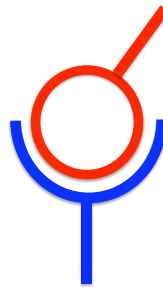
FIG. 3.9 – Représentation schématique d'une liaison rotule
